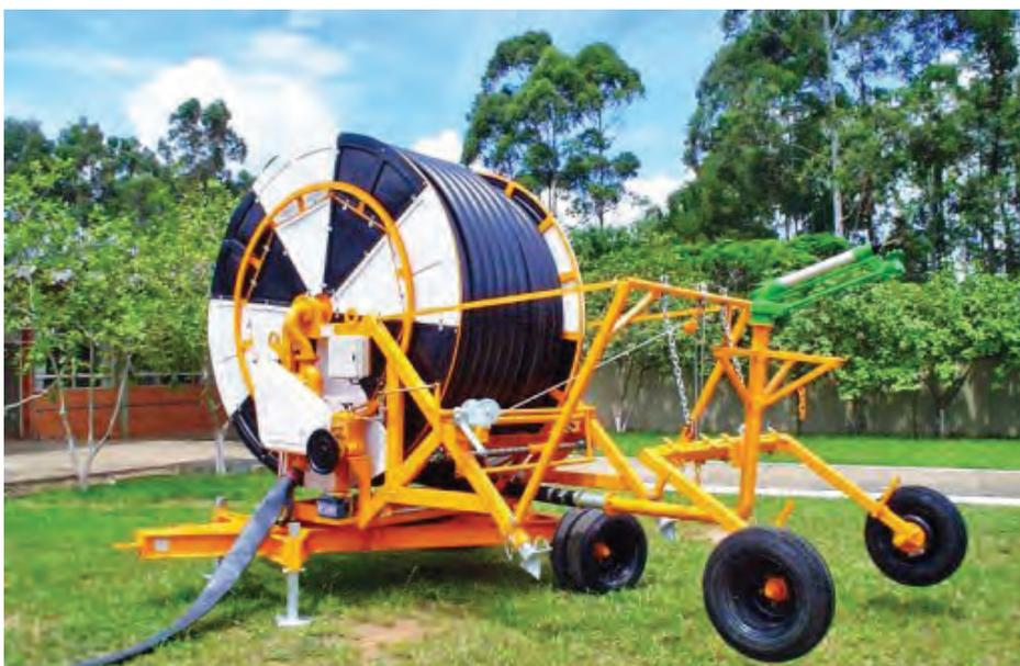
Figura 13 - Método de irrigação por autopropelido
