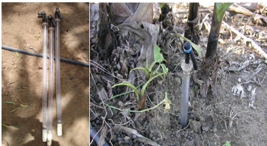
Figura 7 - Extratores de solução no campo
