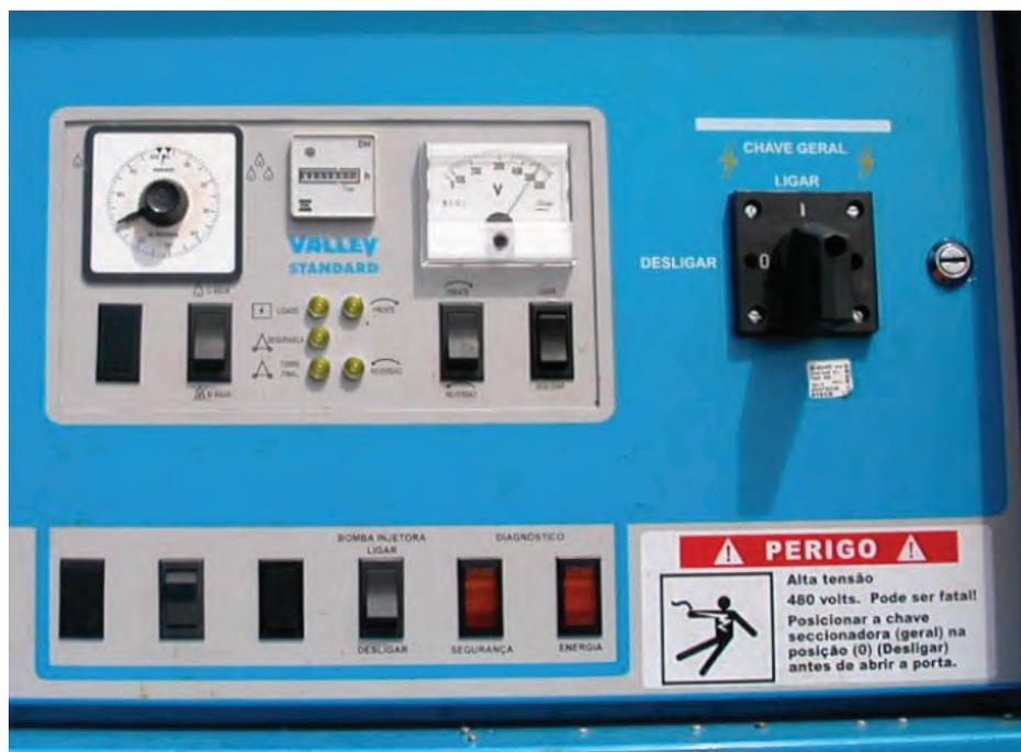
Figura 10 - Painel central analógico de pivô central
