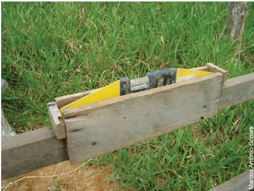
**Figura 21** - Nível de pedreiro, instalado na parte central do esquadro.
