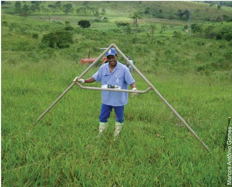
**Figura 20** - Esquadro do tipo triangular feito com cano de PVC de 50 mm.
