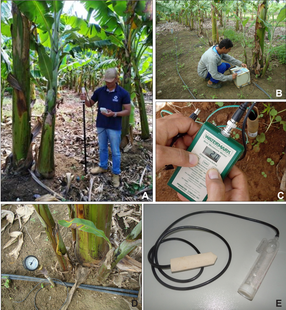
Figura 9.5 - Sensores para monitoramento de água do solo
