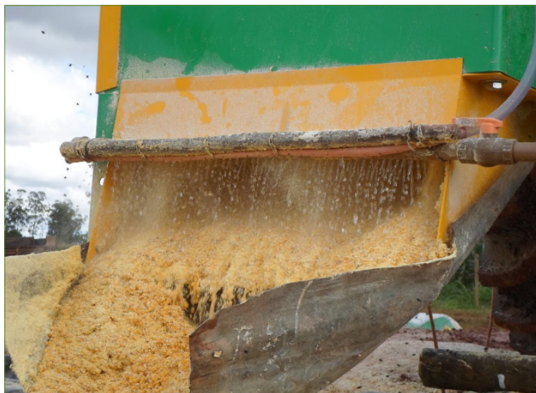
Figura 12 - Moinho adaptado para mistura do milho moído com água
