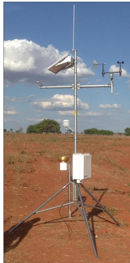
Figura 1 - Estação meteorológica automática localizada no Norte de Minas
