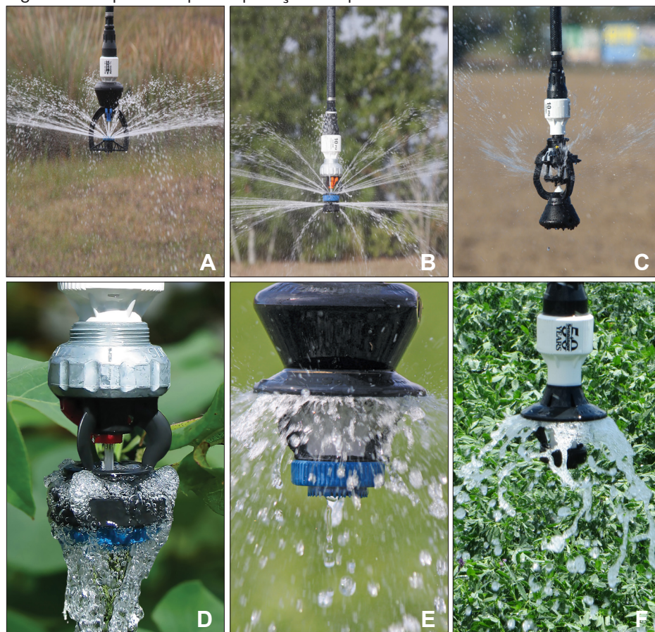
Figura 2 - Aspersores para aplicação em pivô central
