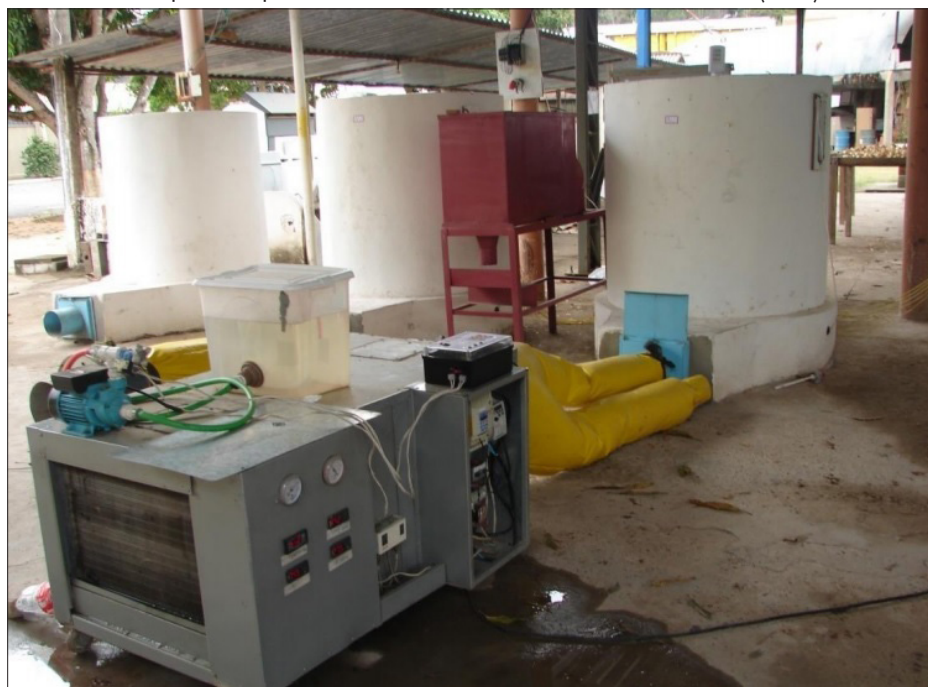
Figura 3 - Cura de cebolas em silos por desidratação artificial utilizando ar aquecido por meio da unidade de tratamento de ar (UTA)
