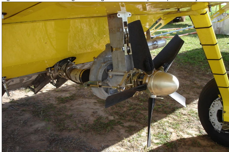
Figura 4 - Bomba centrífuga de energia eólica usada para a pressurização da calda
