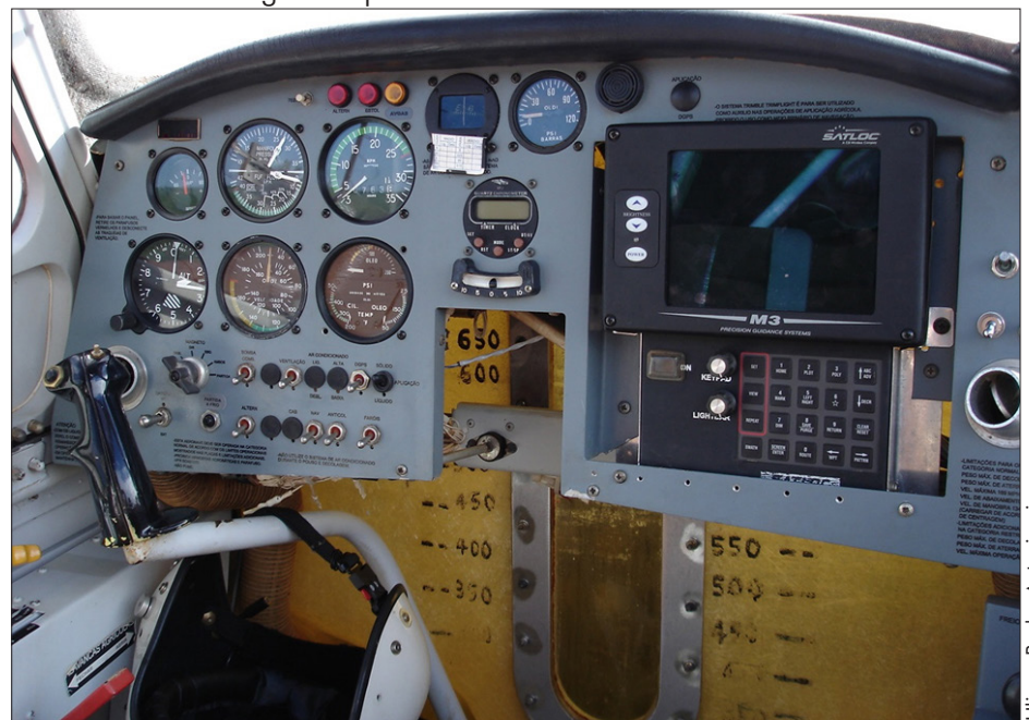
Figura 9 - Sistema de navegação e controle de fluxo Satloc M3 instalado na aeronave agrícola Ipanema
