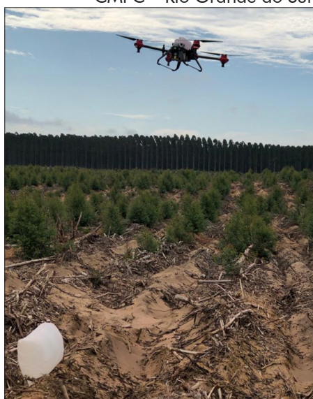
Figura 7 - Drone XAG P20 em operação na empresa Florestal CMPC – Rio Grande do Sul
