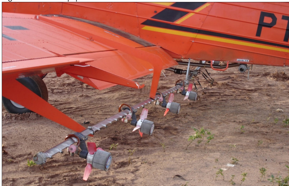
Figura 7 - Barra equipada com atomizadores rotativos de tela Micronair AU-5000
