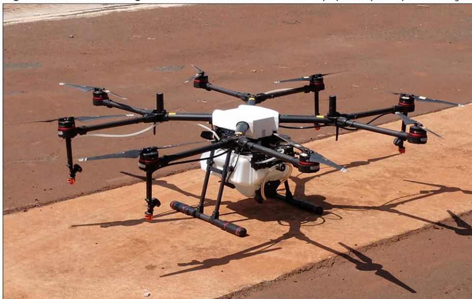
Figura 3 - Drone DJI Agras MG1-S com oito rotores, equipado para pulverização
