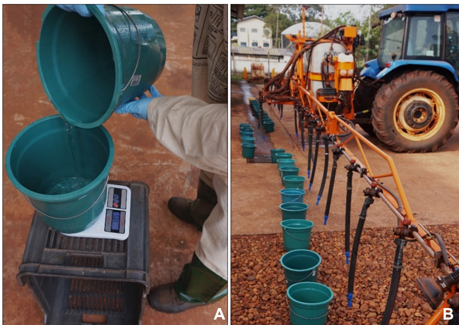
Figura 2 - Coleta da água para medição da vazão das pontas com balde
