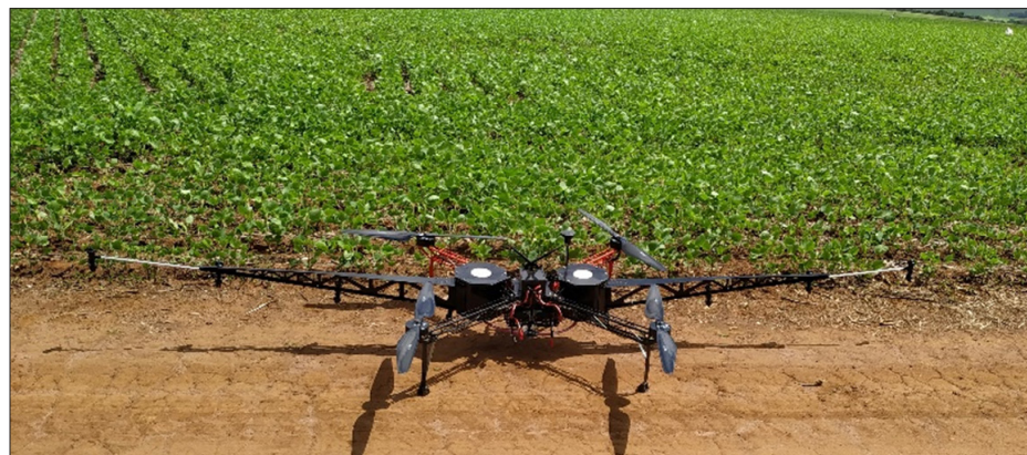
Figura 4 - Drone Arpac equipado com sistema de pulverização de barras com seis bicos hidráulicos
