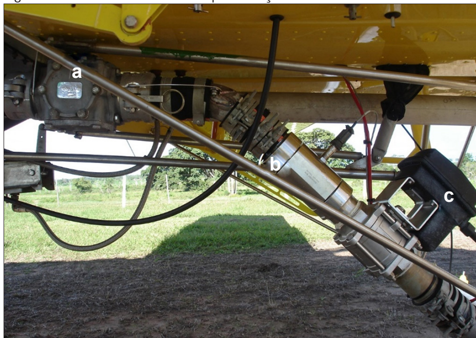
Figura 5 - Sistema de controle da pulverização
