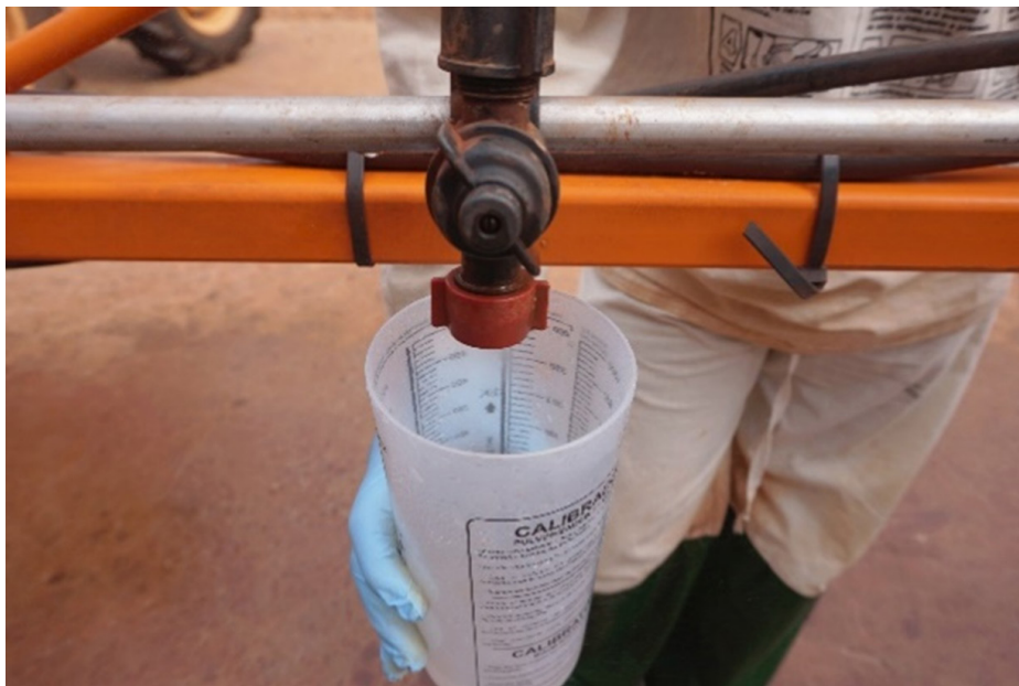
Figura 1 - Coleta da água para medição da vazão com vaso calibrador graduado
