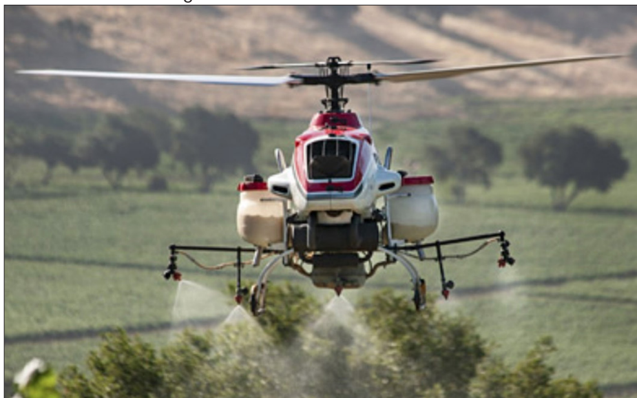
Figura 1 - Drone Yamaha RMAX, lançado em 1997 com capacidade de carga útil de 28 kg
