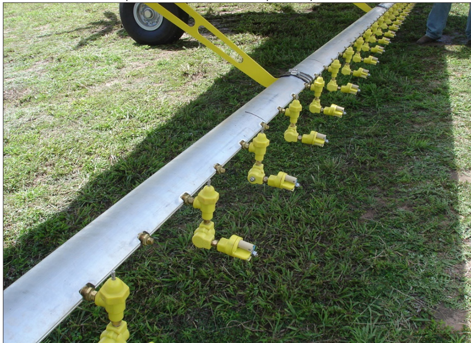
Figura 6 - Barra equipada com pontas hidráulicas de jato plano e corpo do bico CP-11TT, que acomodam até três pontas por bico
