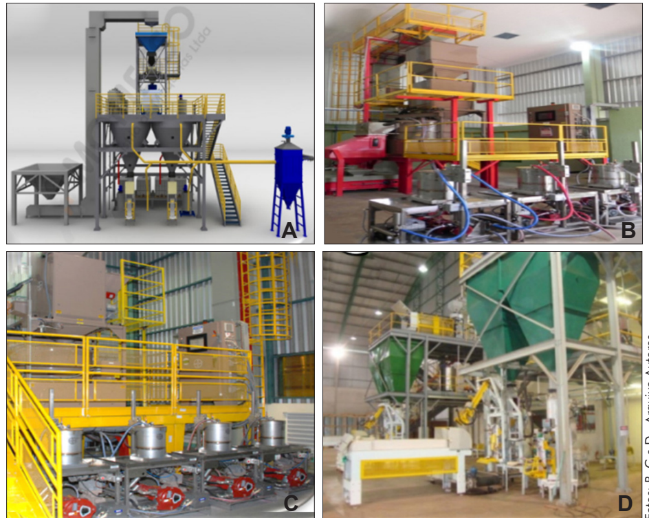
Figura 2 - Equipamentos utilizados para o tratamento de sementes industrial (TSI)
