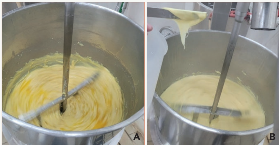
Figura 3 - Processo de fusão dos queijos em tacho aberto
