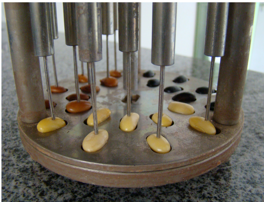
Figura 3 - Disposição dos grãos de soja no cozedor tipo Mattson
